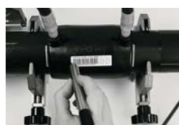
Phase 6 réglage des paramètres de soudure avec crayon optique
