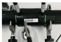
Fase 6 impostazione dei parametri di saldatura con penna ottica
