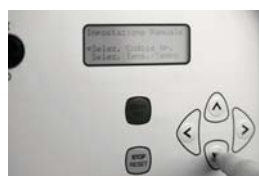
Fase 6 o ajuste de los parámetros de soldadura manual
